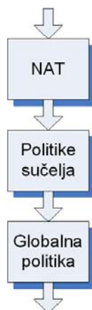
Slika 7: Redoslijed primjene pravila za filtriranje paketa
