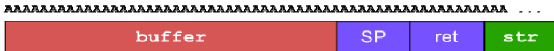
Slika 2. Izgled stoga nakon prepisivanja međuspremnika buffer . Spremljeni stack pointer (EBP) i povratna vrijednost (EIP) prepisani su s 0x41414141 (četiri znaka 'A').
