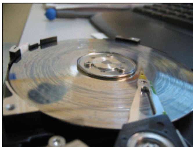
Slika 1. Fizičko oštećenje tvrdog diska
